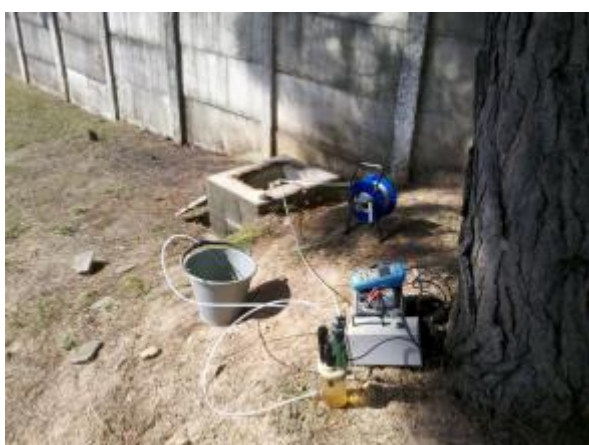
Foto 5 – Amostragem por baixa vazão com a utilização de bomba peristáltica.
