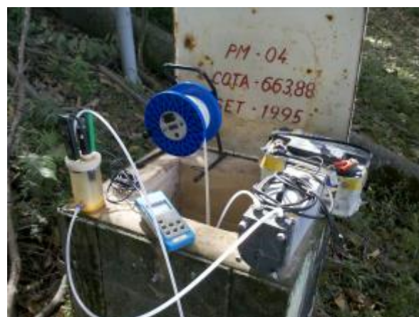
Foto 4 – Amostragem pelo método de baixa vazão em poço de monitoramento.
