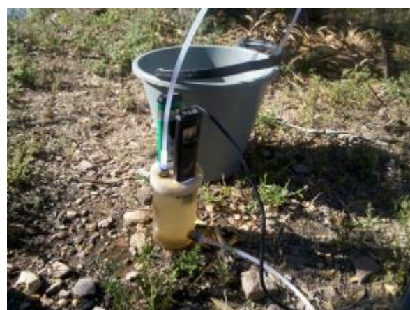
Foto 6 – Detalhe da célula de fluxo utilizada e conjunto multiparâmetros para leitura de parâmetros físico-químicos.
