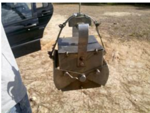
Foto 3 – Detalhe de Draga do tipo Eckman, utilizada no presente estudo.
